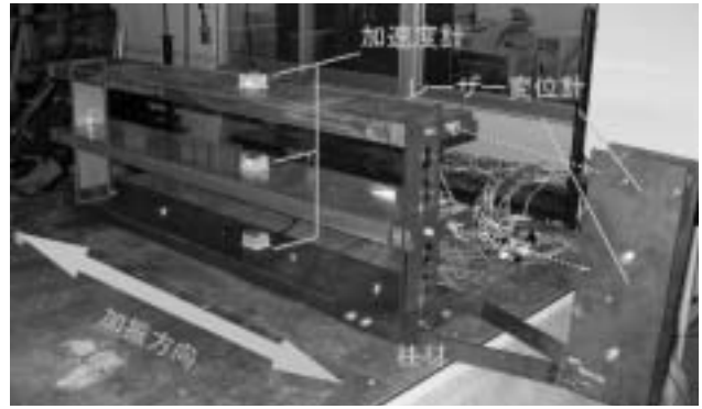
写真1. 試験体設置状況
