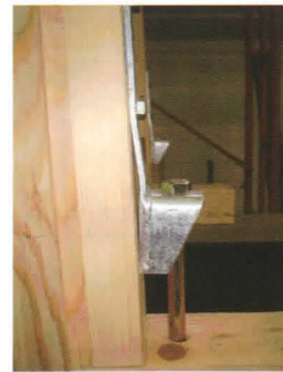
(b)HD 金物接合合板壁付試験体 (WHS) の破壊状況 (左: 金物変形 1/120rad, 右: 合板が浮き釘が抜けた 1/60rad)
