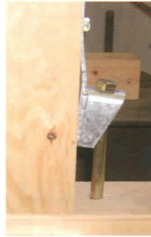
(a)筋かい付試験体 (BHS) の破壊状況 (左: 金物変形 1/240rad, 右: 筋かい座屈折損 1/60rad)
