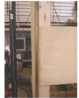
(c)込栓接合合板壁付試験体 (WCS) の破壊状況 (左: 合板が浮く 1/120rad, 右: 釘が抜けた 1/60rad)
