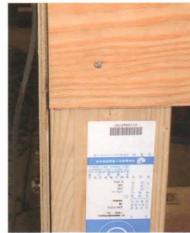
(c)込栓接合合板壁付試験体 (WCS) の破壊状況 (左: 合板が浮く 1/120rad, 右: 釘が抜けた 1/60rad)
