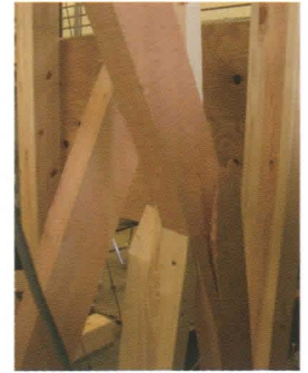
(a)筋かい付試験体 (BHS) の破壊状況 (左: 金物変形 1/240rad, 右: 筋かい座屈折損 1/60rad)
