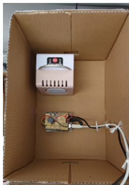
Fig. 28 オゾン濃度測定時のオゾン発生装置と測定装置の配置写真
