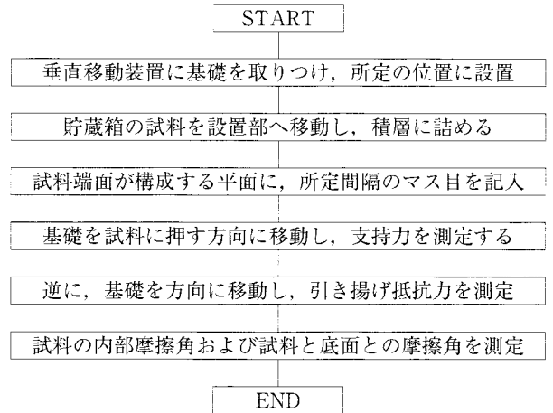
図-12 基礎の支持力実験方法
