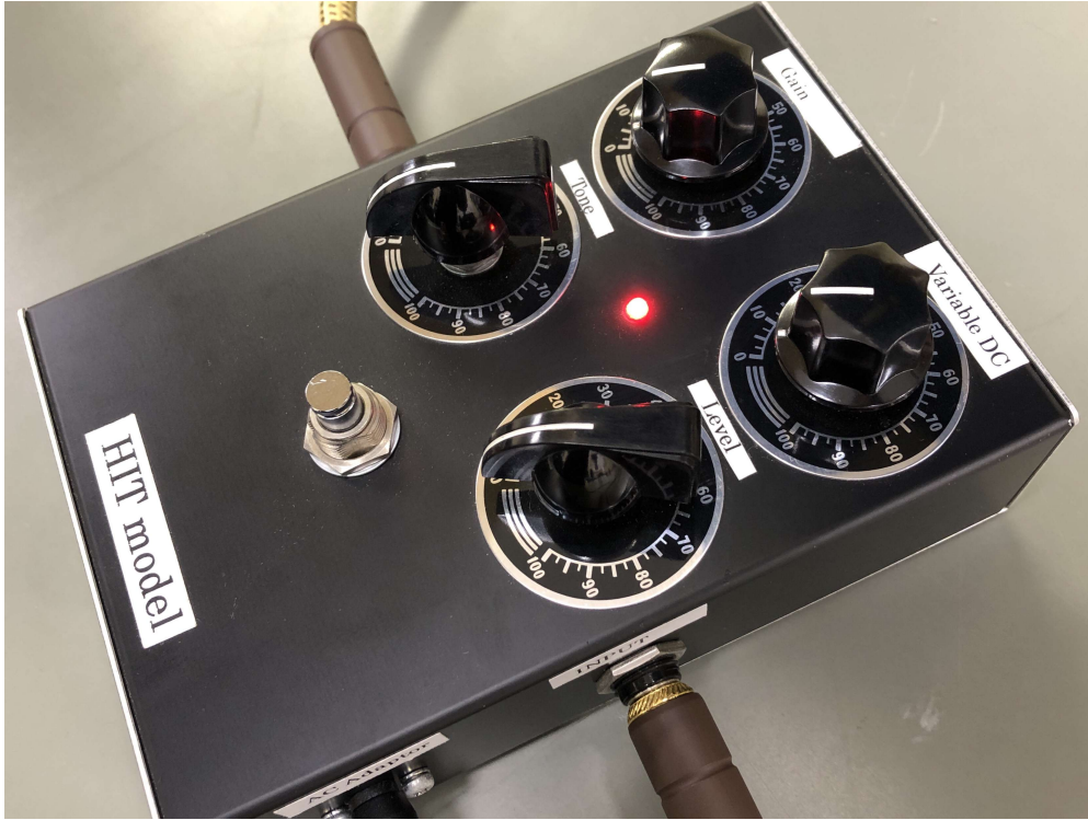
図 5.5: 4つのノブが搭載された新たに製作された歪ペダル: “Gain”, “Tone”, “Level”, フィードバック抵抗 \mathrm{VR}_4 を制御する “Variable DC” ノブが搭載されている, 歪の変化は, “Gain” ノブ D1 と “Variable DC” ノブ D2 の組み合わせにより制御される (Copyright(C)2020 AES [70] Fig.5)
