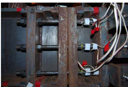
写真 6 試験体継手最大変形時
