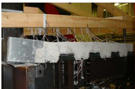
写真 19 実験中のスラブひび割れ 1(最大変形時)
