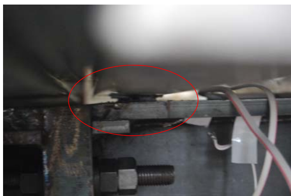
写真 23 実験中の焼抜き栓溶接
