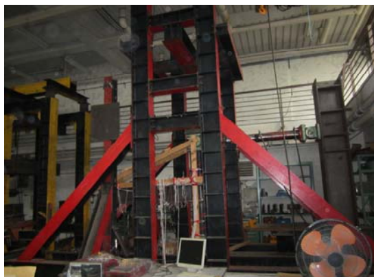
写真 1 載荷装置と試験体
