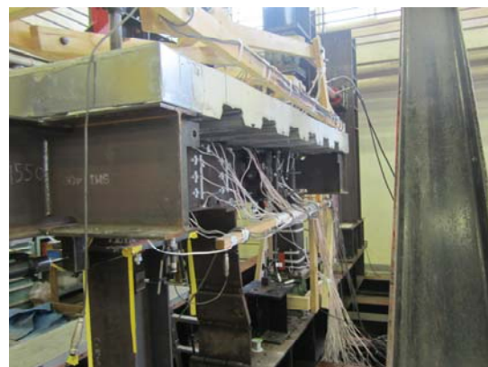
写真 16 ひずみゲージ貼付け状況
