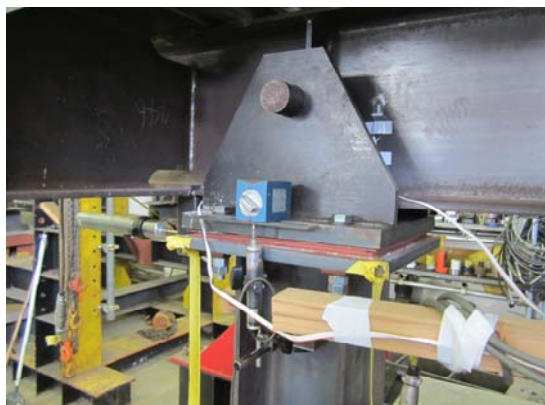
写真 11 ローラー支点
