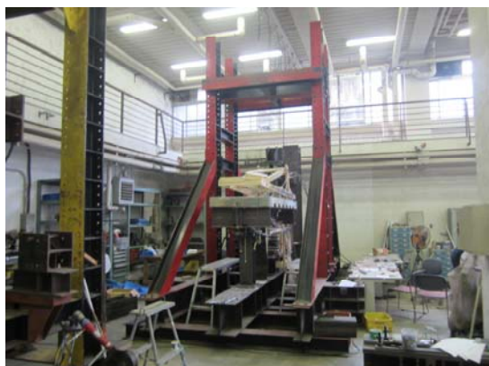
写真 9 荷重装置と試験体
