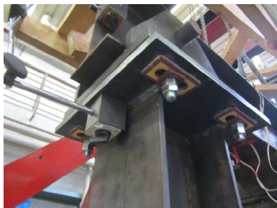
写真 4 ローラー支点(下から撮影)
